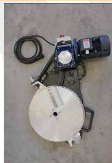
Fresa elettroidraulica \ Elettro-hydraulic cutter
